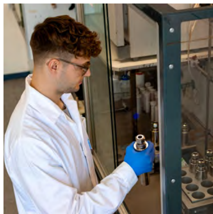
Frank Sailer bestückt den Heizblock mit einem Reaktionsgefäß für die Ein-Topf-Synthese. Copyright: Dr. Robert Pazdzior
