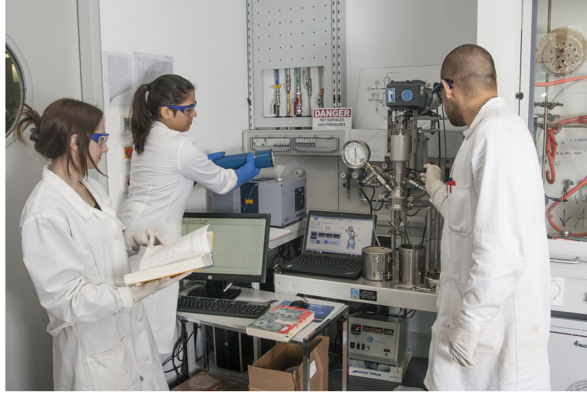
Mitarbeiter der Arbeitsgruppe von Prof. Unterlass bereiten einen Versuch mit Hochtemperatur-Infrarotsonde und Reaktor vor. Quelle: TU Wien
