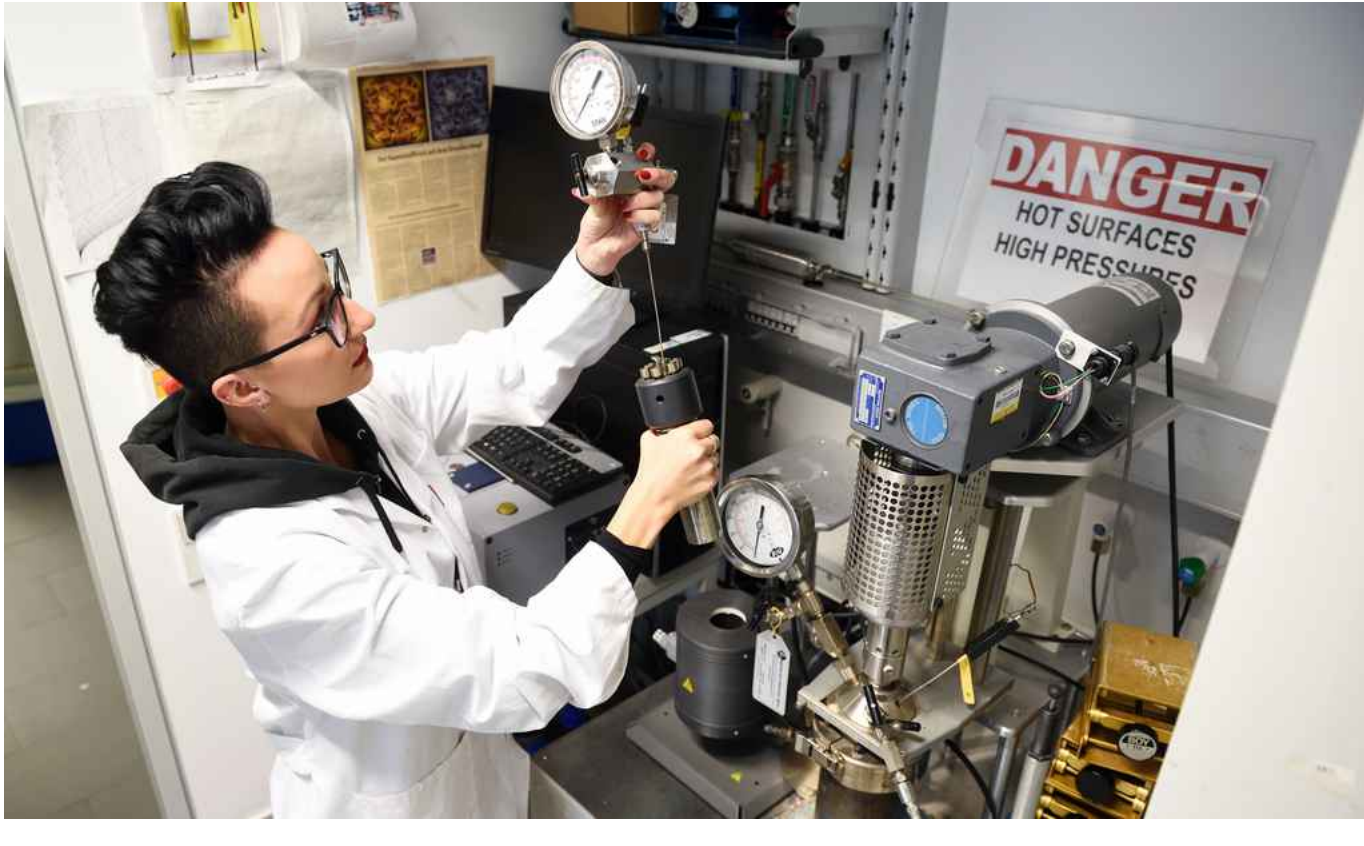
Mit speziellen Druckreaktoren stellt Miriam Unterlass an der TU Wien in einem umweltfreundlichen Verfahren verschiedenste organische Substanzen wie Farb- oder Kunststoffe her. Für ihre innovative Arbeit erhielt die Chemikerin einen hoch dotierten Start-Preis. (c) Die Presse (Clemens Fabry)
